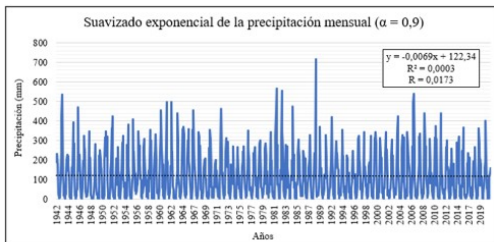
Figura 9: Tendencia de la precipitación mensual de Carmo do Paranaíba/MG, Brasil por el método de suavizado exponencial de precipitación mensual (1942-2020)
