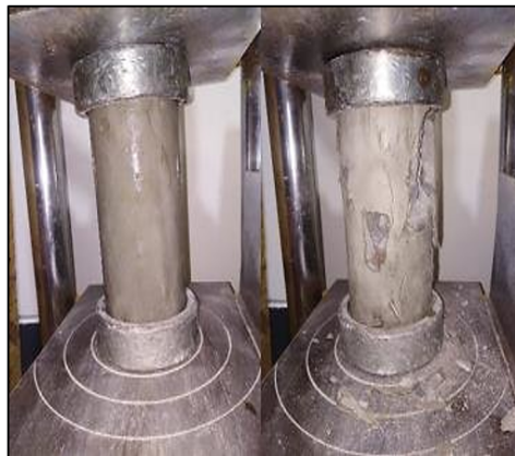
Figura 1: Ensayo de resistencia a la compresión de probetas cilíndricas.
