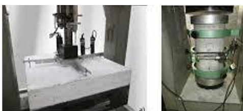
Figura 4: Ensayo del Módulo de Elasticidad Sobre Probetas Cilíndricas.
